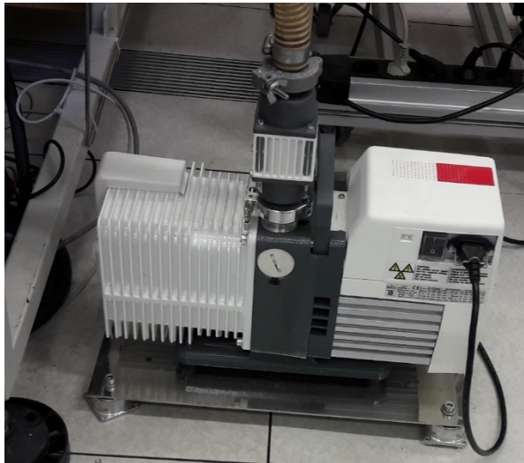
Figura 4. Pompa rotativa a due stadi Pascal 2021 HW della Pfeiffer.
