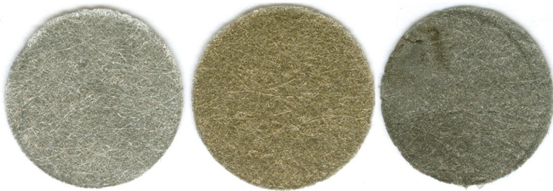
Figura 4. Fotografie degli anodi di Ni (sx), Ni-Co (c) e Ni-Pt anodes (dx).
