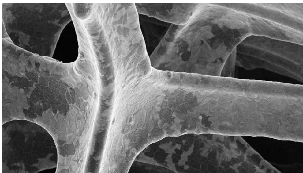
Figura 2. Micrografia SEM di una crescita di grafene 3D. Sono visibili le caratteristiche grinze o “wrinkles”, le zone di diverso spessore (toni di grigio) ed i cristalliti del nichel
