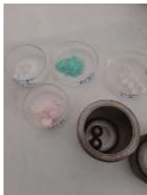
Figura 2. Gli acetati di sodio, nichel, litio e manganese dopo la pesatura; in primo piano la giara del mulino SPEX in cui sarà eseguito il ball milling
