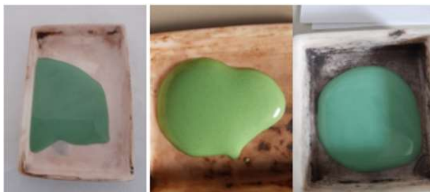
Figura 3. Tre diversi esempi di miscela di acetati precursori dopo il trattamento di ball milling, rispettivamente da sinistra il materiale 3, 4 e 5.
