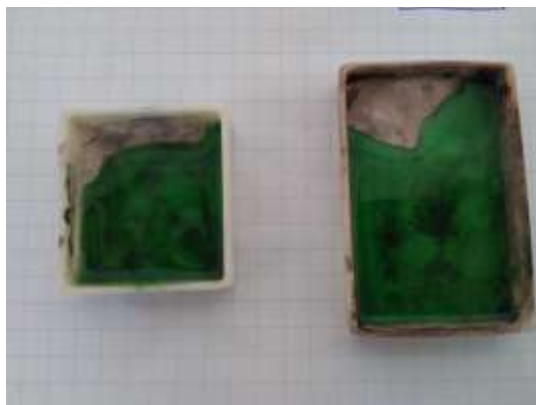
Figura 5. La miscela di acetati precursori dopo il miscelamento in soluzione acquosa, rispettivamente da sinistra il materiale 1 e 2.
