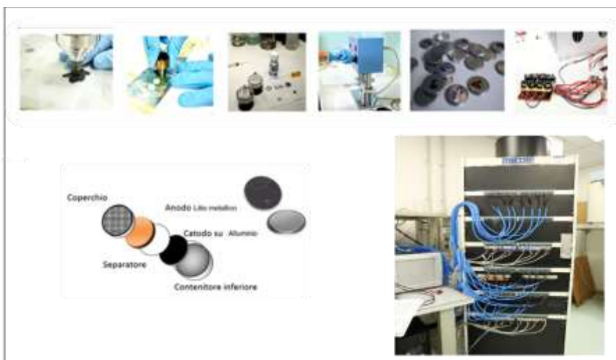
Figura 19. Fasi di assemblaggio di una cella a bottone e sistema di test batteria Maccor serie 4000
