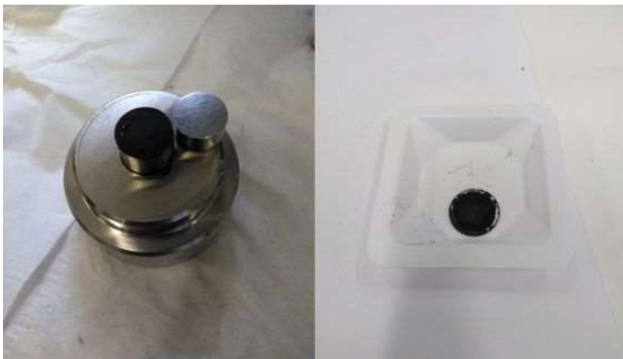
Figura 17. Anodo ottenuto mediante pressatura a partire da MgH_2 macinato e Super P, MgH_2\_C\_mix\_mill , e utilizzando un anello in teflon come rinforzo.
