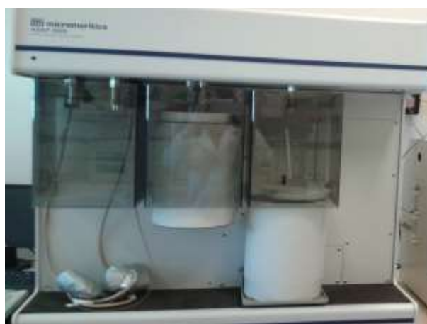
Figura 6. Strumento per analisi BET e BJH della Micromeritics modello ASAP 2020.
