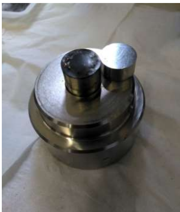
Figura 16. Anodo ottenuto mediante pressatura a partire dalla polvere MgH_2\_C\_mix\_mill e utilizzando un anello in rame come rinforzo.
