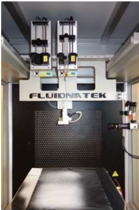
Figura 3. (sinistra) Stazione di elettrofilatura Fluidnatek LE100 di Nanofaber e (destra) schema funzionamento del processo di elettrofilatura.
