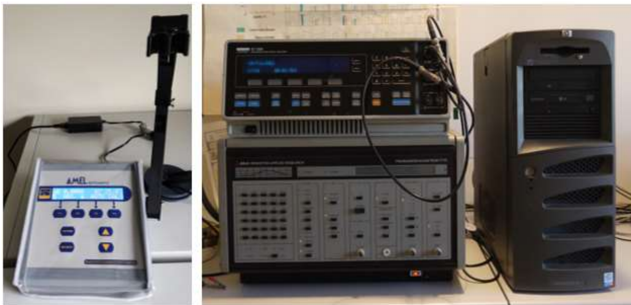
Figura 3. Conduttimetro AMEL 160 (pannello sinistro) e analizzatore alla risposta in frequenza Schlumberger Solartron 1260 (pannello destro) impiegati per la determinazione della conducibilità ionica specifica delle formulazioni elettrolitiche investigate.
