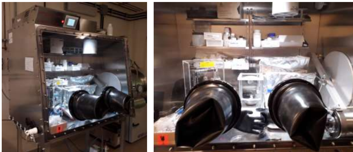
Figura 2. Glove-box ad atmosfera controllata di argon (H 2 O e O 2 < 1 ppm) impiegata per la manipolazione delle miscele elettrolitiche e l'assemblaggio delle celle elettrochimiche.
