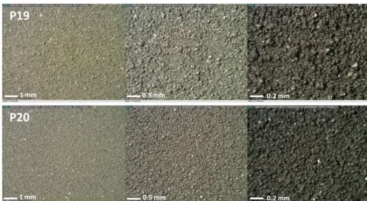
Figura 3. Immagini al microscopio elettronico a diversi ingrandimenti di due stese elettrodiche ottenute setacciando la miscela zolfo/carbone tramite maglie da 125 mesh (campione P19) e tramite maglie da 65 mesh (campione P20).
