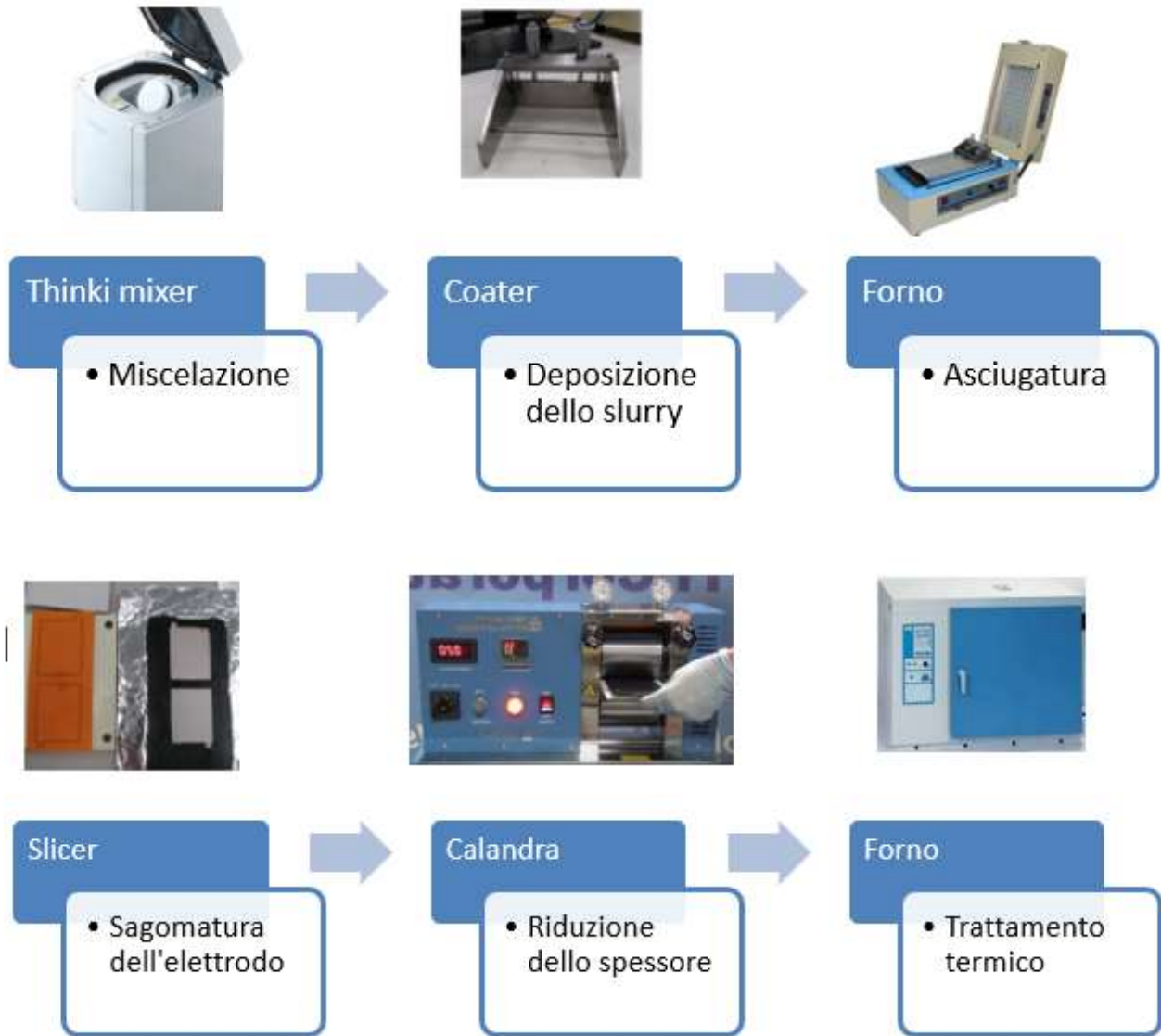
Figura 4. Operazioni unitarie per la realizzazione delle stese elettrodiche.
