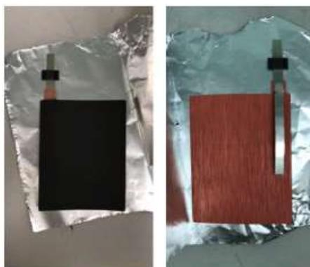
**Figura 3: saldatura con i tab provvisti di guaina di PE per il confezionamento delle pouch cell**
