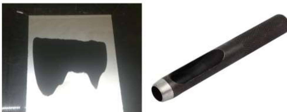
**Figura 11.** Miscela elettrodica spalmata sul foglio di alluminio (sinistra), e punzonatrice manuale (destra).
