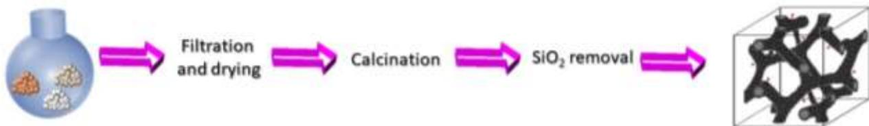
**Figura 32.** Procedura di sintesi dell'ossido misto mesoporoso attraverso la tecnica del nanocasting, con un unico passaggio di infiltrazione.
