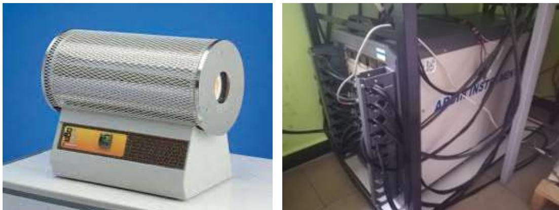
**Figura 9.** Immagini del sistema di pirolisi Carbolite TZF utilizzato per la pirolisi delle biomasse (sinistra) e del ciclatore multicanale ARBIN BT2000 (destra).
