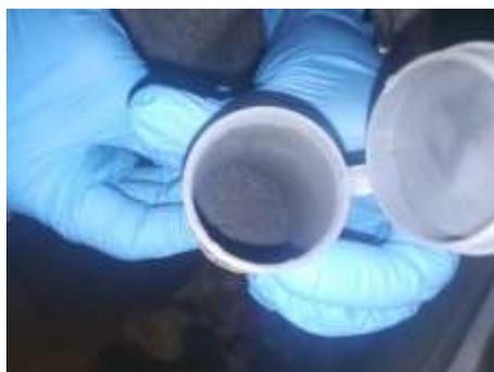
**Figura 10.** Immagine di una biomassa a seguito del processo di pirolisi in atmosfera controllata (biochar).
