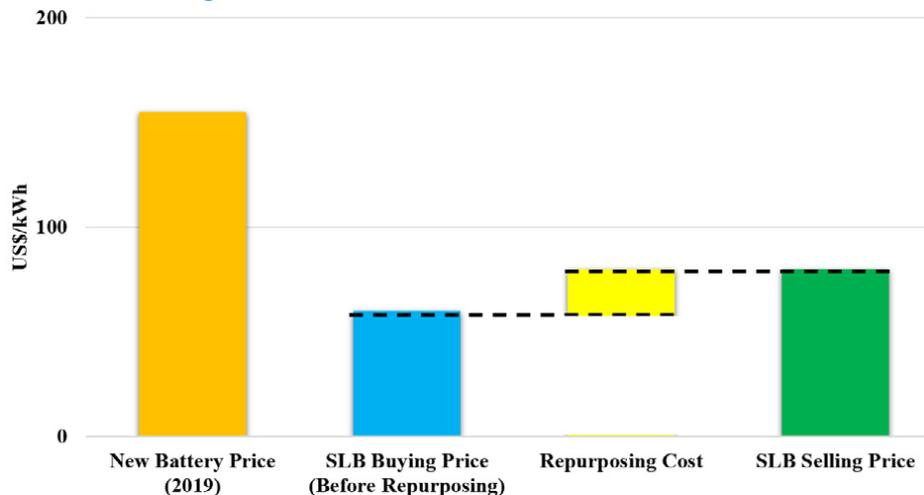
Figura 13 Comparazione dei costi tra un pacco batteria nuovo e uno di second-life [23]
