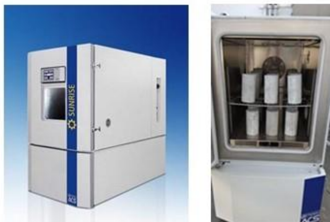
Figura 2-2 Camera climatica Sunrise SU340 Angelantoni e disposizione di alcuni provini
