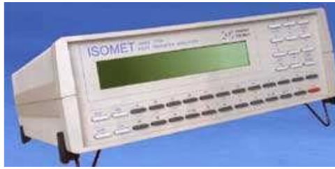
Figura 2-7 Dispositivo di misura della conducibilità termica (ISOMET, mod.2104).
