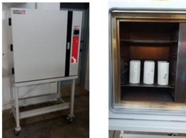
Figura 2-4 Forno CARBOLITE modello LHT-6/120 e disposizione di alcuni provini.
