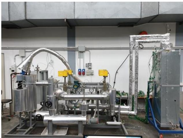
Figura 1- Prototipo ENEA-TES-LH01 da circa 7kWh installato sull'impianto sperimentale Solteca3
