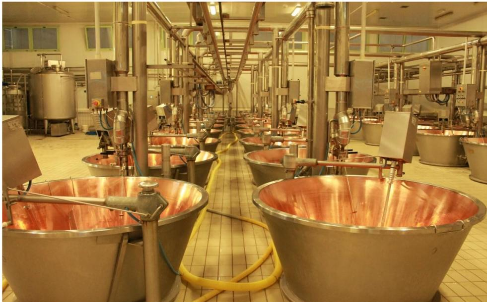
**Figura 14. Sala lavorazione stabilimento Grana Padano: caldaie (tronco coniche) produzione formaggio**
