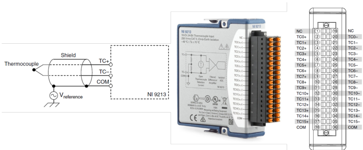
Figura 9. Modulo NI-9213 a 16 ingressi TC. A sinistra schema dei collegamenti. Al centro vista d'insieme. A destra schema della morsettiera.
