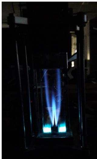
**Figura 4. Immagine di una fiamma premiscelata per una miscela di 50% CH<sub>4</sub> e 50% H<sub>2</sub> in condizione stabile nel bruciatore ROMULUS.**
