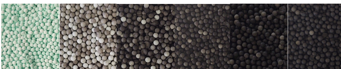
Figura 7. Foto del catalizzatore impregnato su allumina preformata. Da sinistra: campione essiccato con carico del 5 %; campione calcinato con carico del 5 %, 10 %, 15 %, 20 % e 25 %.
