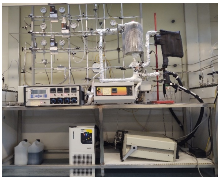
Figura 1. Immagini dell'impianto sperimentale utilizzato per la sperimentazione qui riportata. Impianto equipaggiato con 1 reattore a letto fisso e un microGC.
