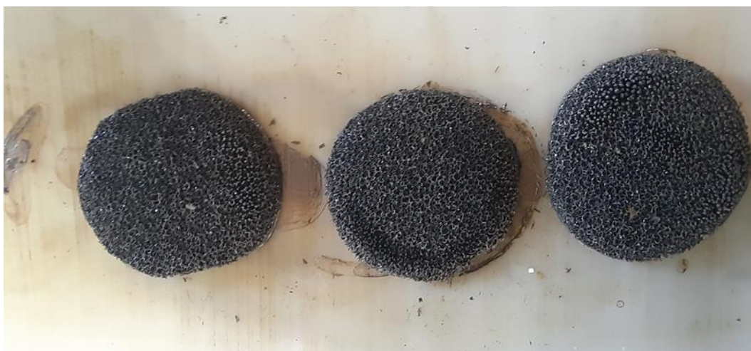
Figura 7. I campioni dopo la deposizione di nanoparticelle di silicio.
