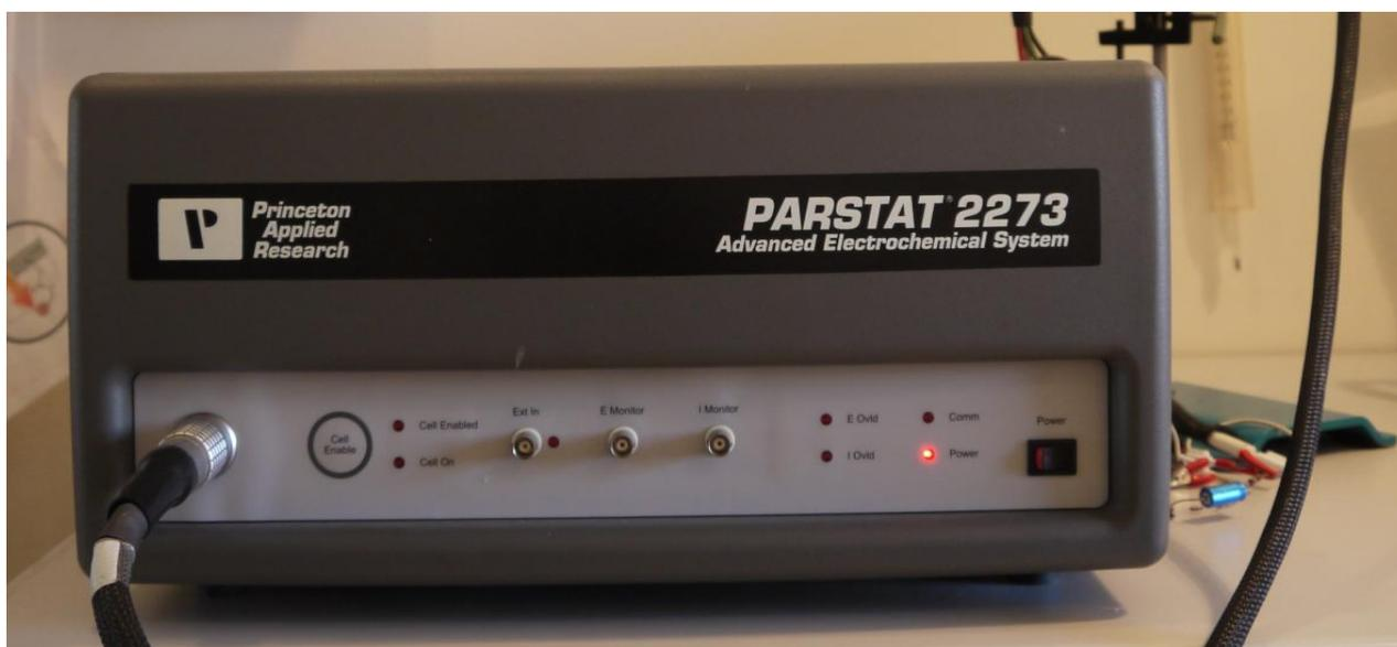
**Figura 5. Potenziostato/galvanostato, combinato con un ponte di impedenza, utilizzato per le misure voltammetriche.**
