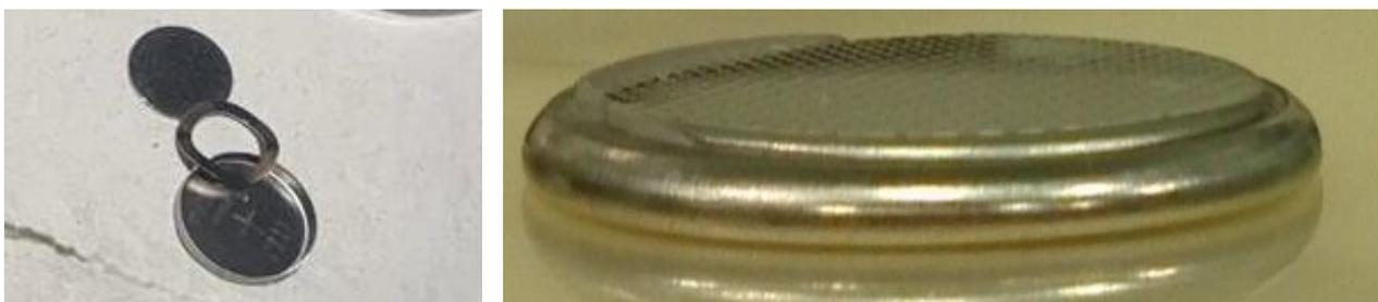
**Figura 3. Coin-cell 2032 realizzata per l'esecuzione delle misure elettrochimiche.**
