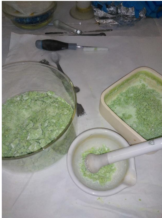
Figura 5 – Foto del gel essiccato e sottoposto ad una prima macinazione con mortaio
