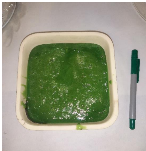
Figura 3 – Foto del gel risultante dalla miscelazione dei quattro Sali di Acetato prima del trattamento termico
