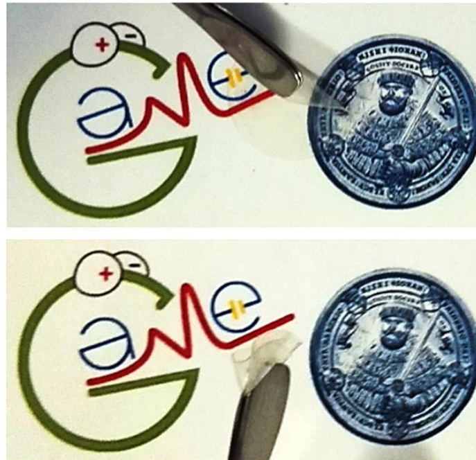
Figura 2. Fotografie digitali della membrana polimerica fotoreticolata PEO_HPyr oggetto di studio, con indicazione dell'elasticità e stabilità meccanico-strutturale.
