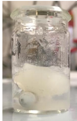
Figura 12 Chitosano reticolato con acido succinico ed EDC
