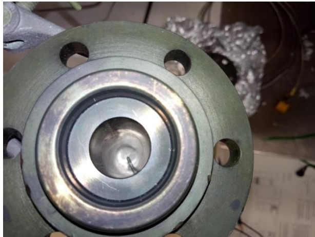
Figura 16. Particolare del reattore senza riempimento, con setto poroso alla base.
