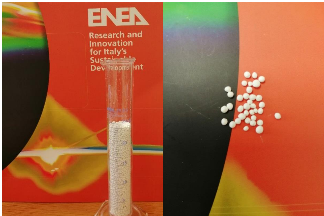
Figura 10. Particolare del riempimento del letto fisso (a sinistra) e delle pellets ( a destra).
