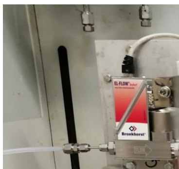
a) Particolare dei mass flow controllers MFC per l'alimentazione dei flussi gassosi di azoto e di anidride carbonica
