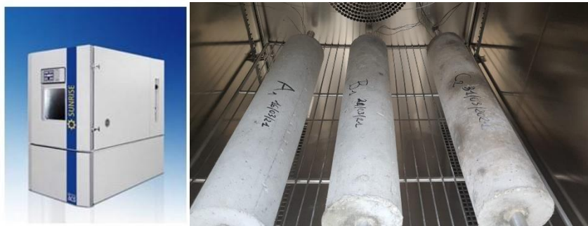
Figura 3-2 Camera climatica Sunrise SU340 di Angelantoni e tre provini con tubo immerso alloggiati al suo interno
