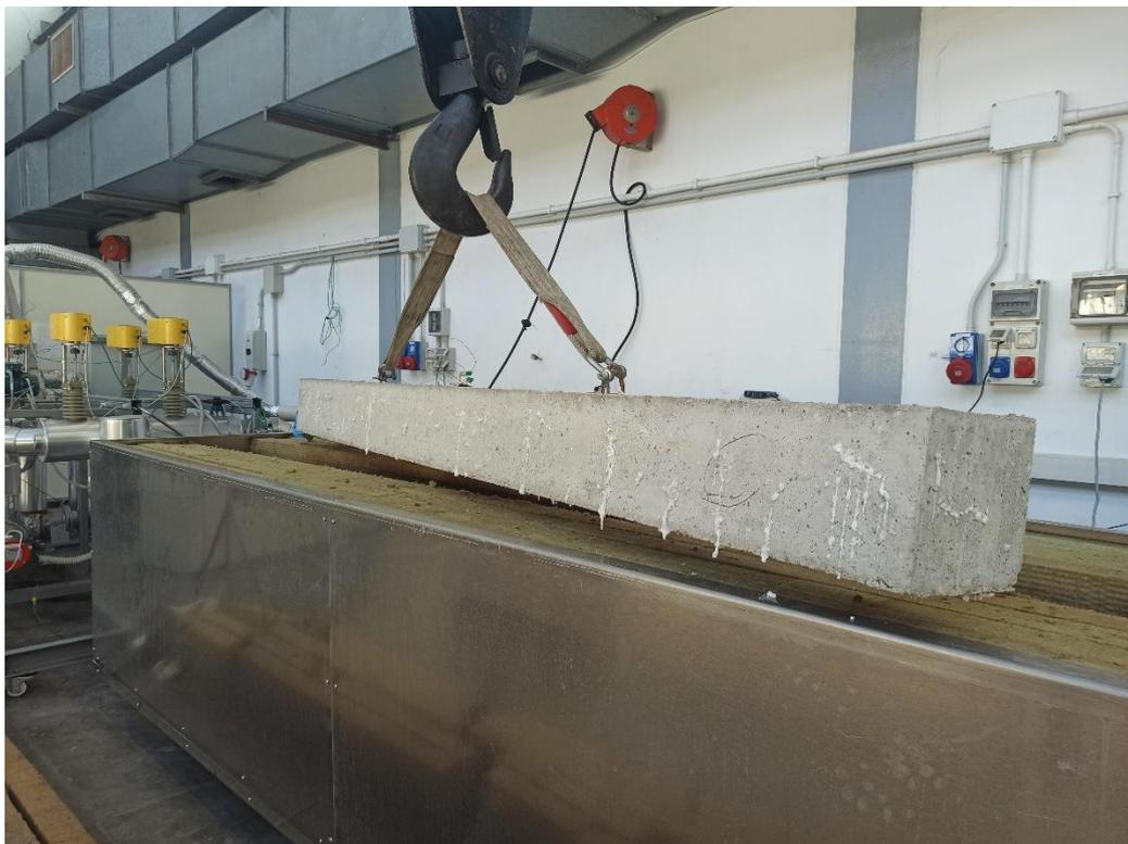
**Figura 3-6 – Inserimento del modulo cementizio all'interno de sistema di coibentazione.**
