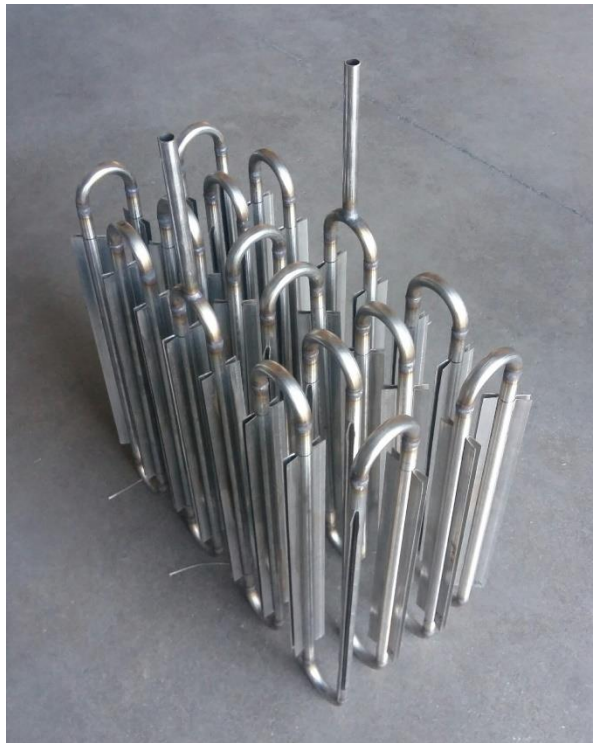
Figura 3- Fasi di assemblaggio dello scambiatore del prototipo ENEA-TES/LH02: i) realizzazione dei singoli tubi alettati; ii) realizzazione di parte di una serpentina; iii) assemblaggio dello scambiatore completo.
