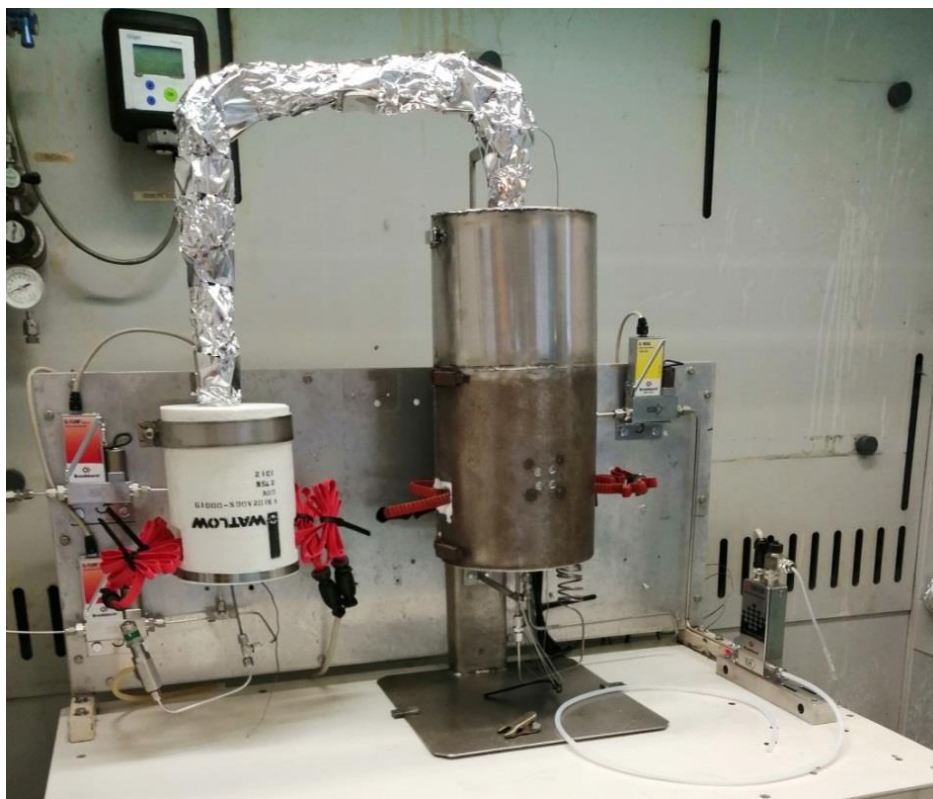
Figura 1. Particolare dell'impianto di carbonatazione/decarbonatazione in scala laboratorio.
