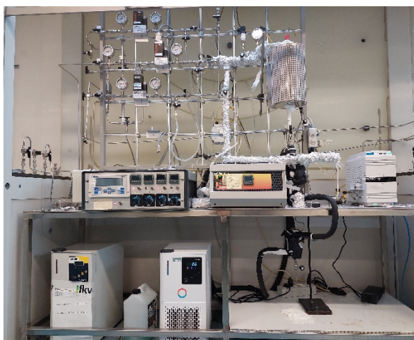
Figura 3. Immagine dell'impianto equipaggiato con un reattore a letto fisso e un microGC;
