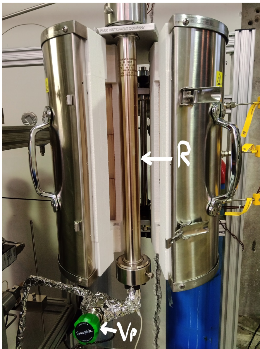
Figura 5. Particolare del reattore tubolare con la valvola regolatrice della pressione
