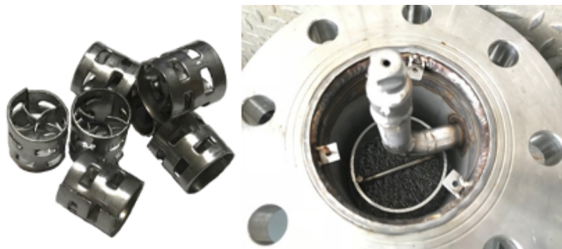
Figura 2.17. Anelli Pall (a sinistra) e particolare interno della testa della colonna con distributore del solvente e demister (a destra).
