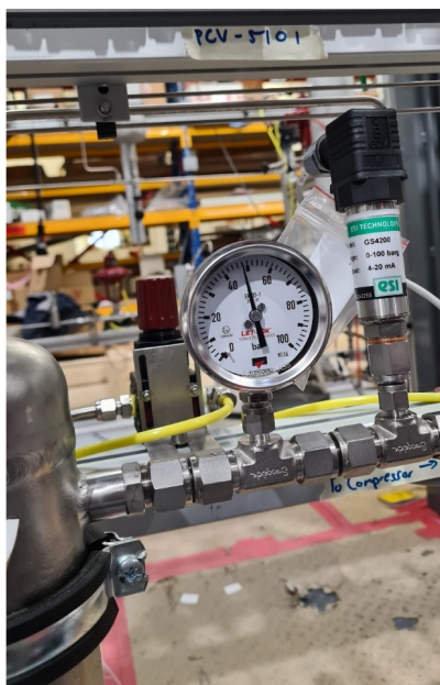
Figura 5.7. Misura di pressione durante la prova di pressione nella sezione di ricircolo.
