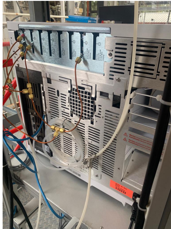
Figura 5.29. Pannello posteriore gas-cromatografo.
