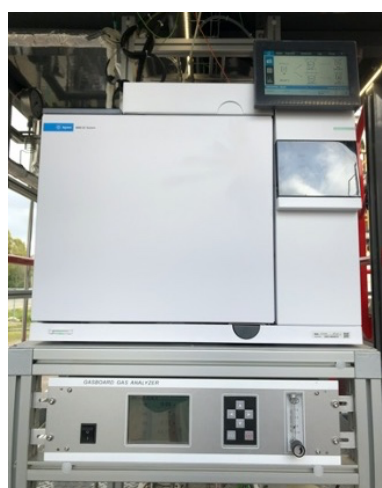
Figura 5.32. Analizzatore gas online (sotto) e gas cromatografo (sopra).
