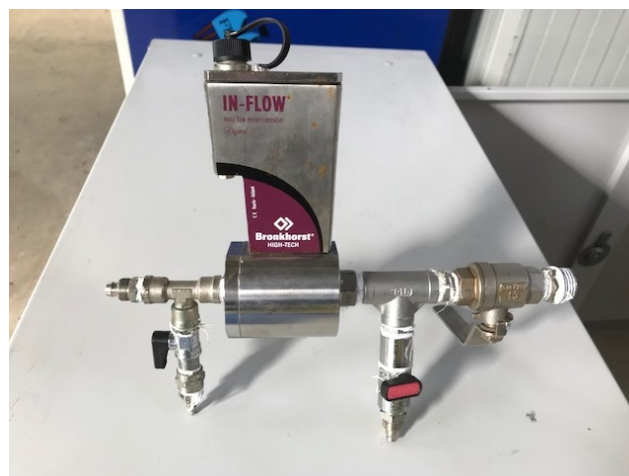
Figura 2.19. Misuratore massico della CO 2 desorbita.
