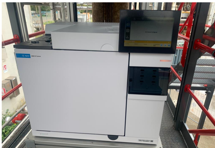
Figura 5.28. Gas-cromatografo per l'analisi delle specie fluide.
