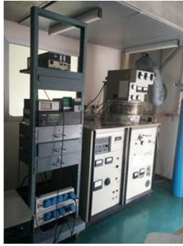
Figura 2. Impianto MRC 8620 per la deposizione mediante PVD.
