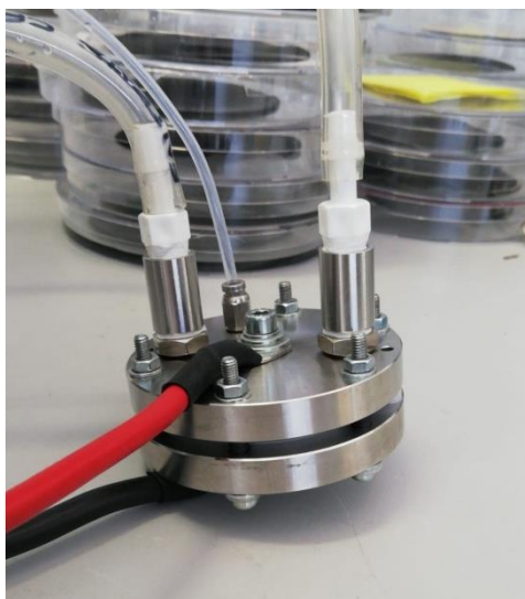
Figura 4. Cella di elettrolisi 2 \text{ cm}^2 per la caratterizzazione dei materiali: membrane ed elettrodi.
