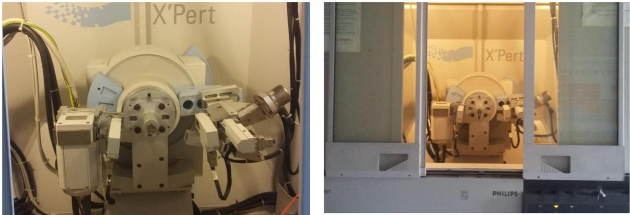
**Figura 3 – Immagine dello strumento di diffrazione utilizzato**
