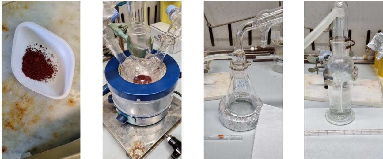
**Figura 8 – Particolari della preparazione del sistema sperimentale per la formazione del solfato di ferro (III): da sinistra, l'ossido di ferro (III)  $Fe_2O_3$  utilizzato, l'inserimento dei reagenti nel pallone con ancorotta magnetica per l'agitazione, la trappola vuota di sicurezza e la trappola contenente una soluzione di NaOH 1N.**
