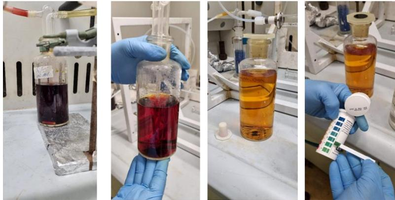
**Figura 14 – Aspetto della seconda trappola prima e dopo la reazione di decomposizione del solfato di ferro (III).**
