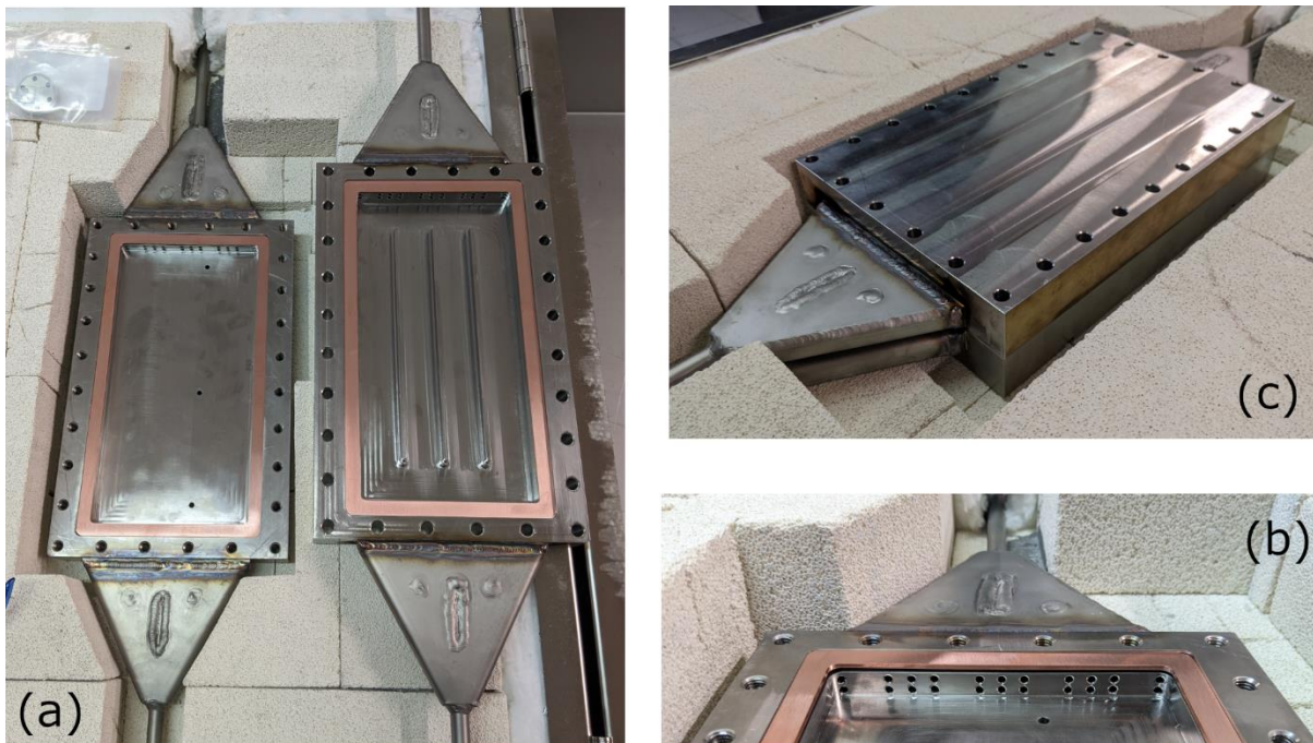
Figura 3 Principali componenti del reattore planare: (a) I due semigusci che compongono il reattore: a sinistra il semiguscio inferiore che delimita il canale di reazione; a destra il semiguscio superiore, che delimita il canale di permeazione (b) Dettaglio della sezione di ingresso del canale di reazione, dove sono visibili i fori per la distribuzione dei gas (c) I due gusci accoppiati prima del serraggio con le viti.
