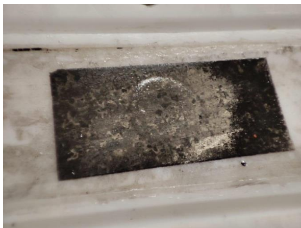
Figura 35: Anodo in litio metallico al termine dei test elettrochimici (Pullulano).
