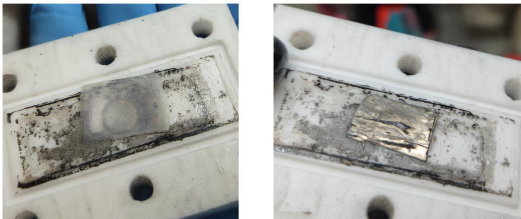
Figura 26. Immagini dell'anodo dopo i test GCPL delle celle WSZ (con Sep2 non modificato, sinistra) e WSPuZ (con Sep2 modificato con pullulano, destra)
