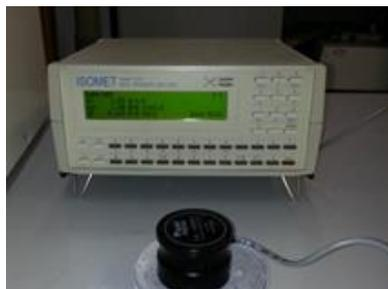
**Figura 19- Sistema ISOMET hot disk**
