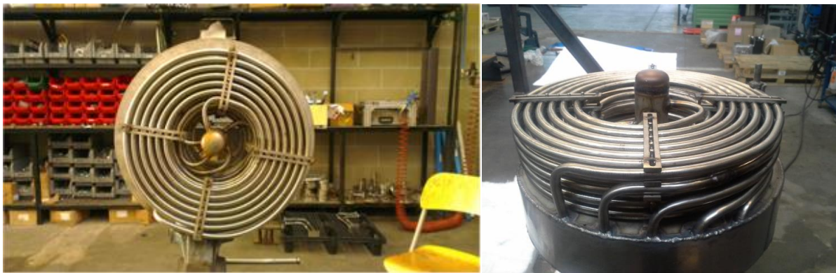
Figura 7. Scambiatori di calore realizzati, prima della loro installazione all'interno del serbatoio.
