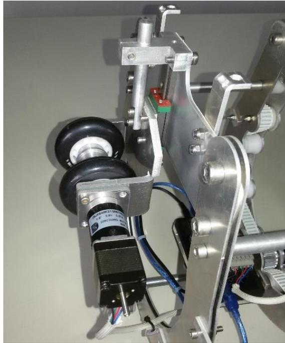
**Figura 7b: Dettaglio del sistema di traslazione orizzontale**
