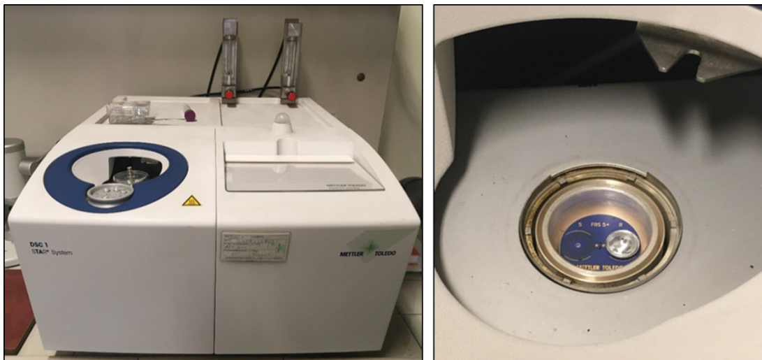
Figura 1 - DSC from METTLER TOLEDO presente nei laboratori ENEA-Casaccia; sulla destra il particolare dell'alloggiamento dei crogioli.
