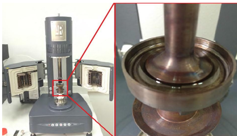
Figura 2 - Reometro AR 2000ex utilizzato e posizionamento del campione per le misure di viscosità.
