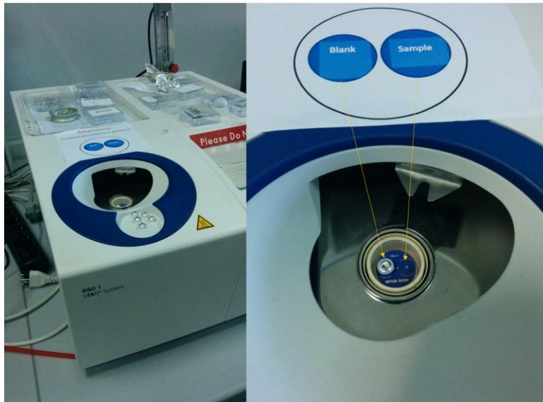
**Figura 1 - DSC utilizzato per le misurazioni. A destra l'apertura dove è possibile posizionare i due crogioli, uno per il campione e l'altro usato come riferimento.**
