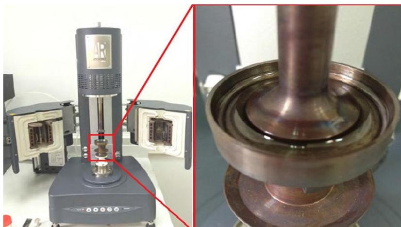
Figura 4 - Reometro AR 2000ex utilizzato e posizionamento del campione per le misure di viscosità.
