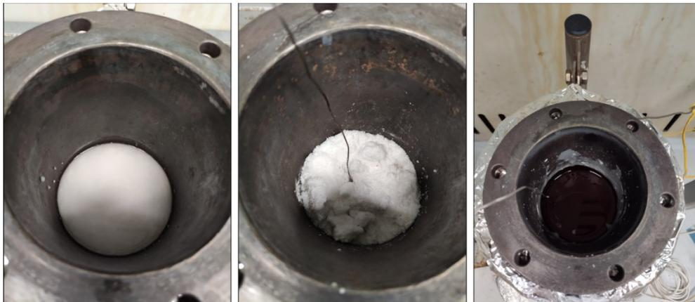
**Figura 2- Procedura impiegata per la misura della densità dei sali: da sinistra sono illustrate in sequenza, la diluizione di composti puri in acqua, la miscela ottenuta e la miscela fusa a temperatura.**
