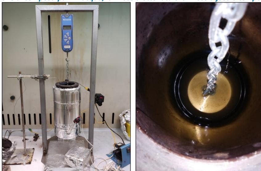
**Figura 3- Apparato sperimentale per la misura della densità: in particolare vengono mostrati il dinamometro, il contenitore e il peso sommerso.**
