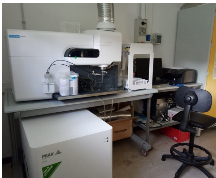
Figura 8 - MP AES 4210- Agilent presente nei laboratori ENEA Casaccia
