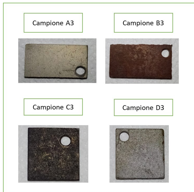
Figura 6 - Provini di acciaio dei campioni A3, B3, C3 e D3 sottoposti al trattamento di descaling dopo 1500 (fine prova) di immersione nella miscela solar salt a 550°C.
