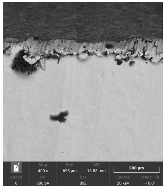
Figura 9 - Analisi SEM del campione A effettuata con un ingrandimento di 400x, l'immagine acquisita con gli elettroni secondari (SED) a sinistra e quella con gli elettroni retro diffusi (BSD) a destra
