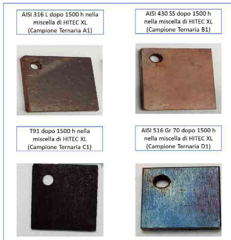
Figura 23 – Foto dei provini dopo 1500 h nella miscela di HITEC XL
