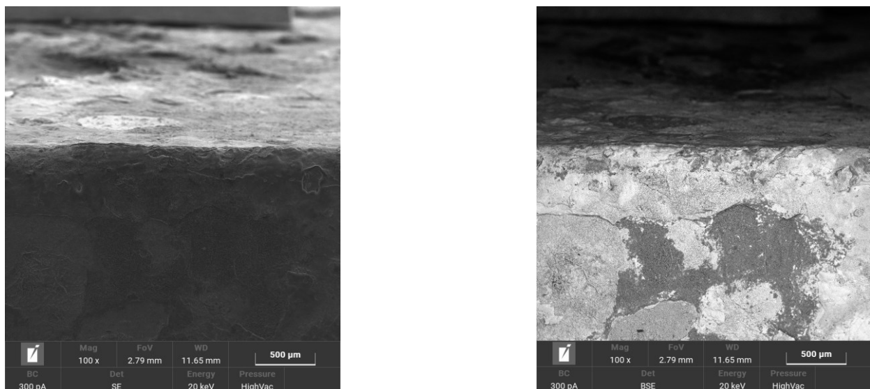
Figura 72 - Analisi SEM del campione D3 effettuata con un ingrandimento di 100x, l'immagine acquisita con gli elettroni secondari (SED) a sinistra e quella con gli elettroni retro diffusi (BSD) a destra
