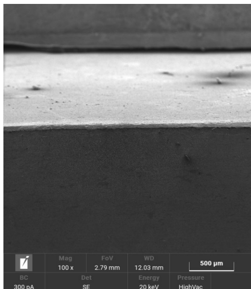
Figura 57 - Analisi SEM del campione A3 effettuata con un ingrandimento di 100x, l'immagine acquisita con gli elettroni secondari (SED) a sinistra e quella con gli elettroni retro diffusi (BSD) a destra
