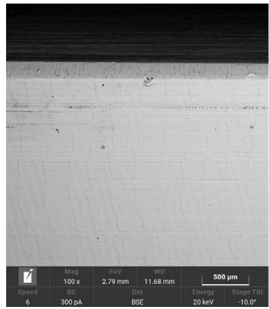
Figura 16 - Analisi SEM del campione C effettuata con un ingrandimento di 100x, l'immagine acquisita con gli elettroni secondari (SED) a sinistra e quella con gli elettroni retro diffusi (BSD) a destra
