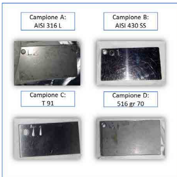
Figura 5 – Foto dei provini metallici prima dei test di corrosione
