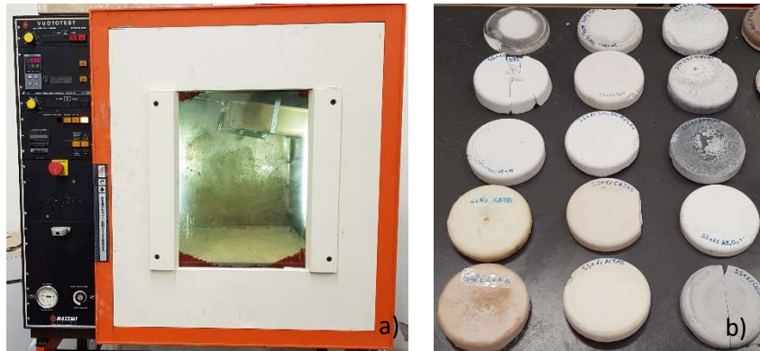
Figura 7. a) Forno utilizzato per il Vacuum Drying e b) dischi di Sali Solari nanocaricati
