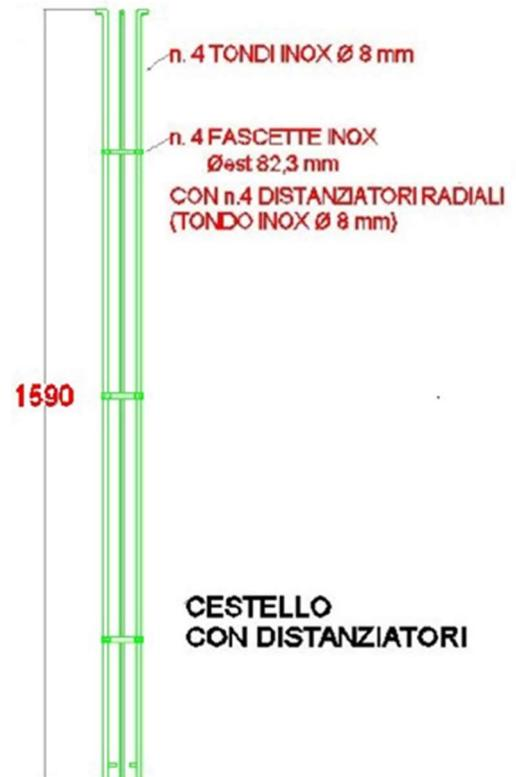
Figura 23- Disegno del cestello porta-capsule del prototipo ENEA-TES-LHC01
