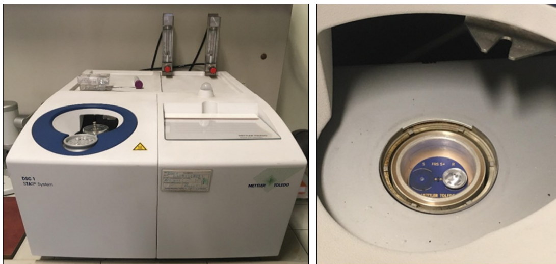
Figura 7 - DSC from METTLER TOLEDO presente nei laboratori ENEA-Casaccia; sulla destra il particolare dell'alloggiamento dei crogioli.
