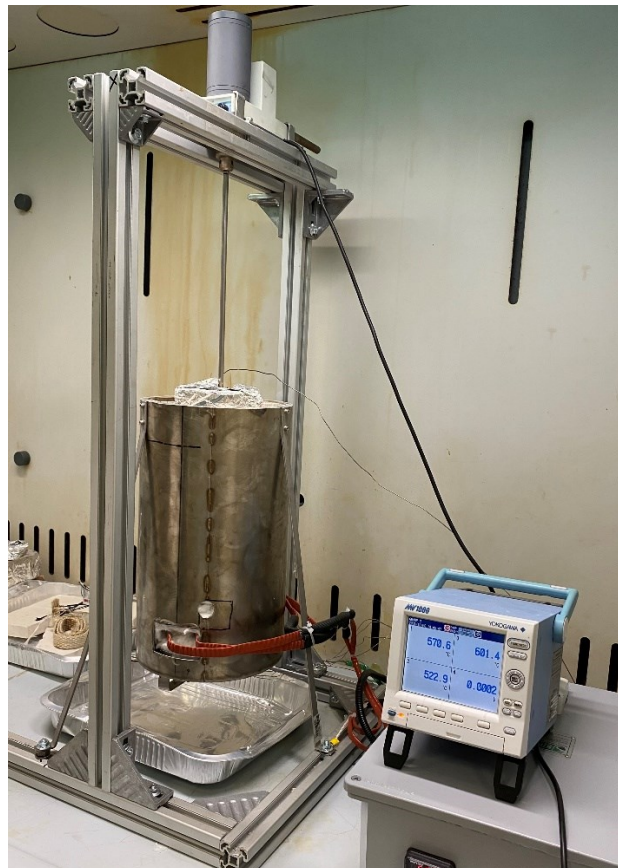
Figura 3 – Setup sperimentale con tutti gli elementi collegati (fascia riscaldante, reattore, impeller e controllore di temperatura)
