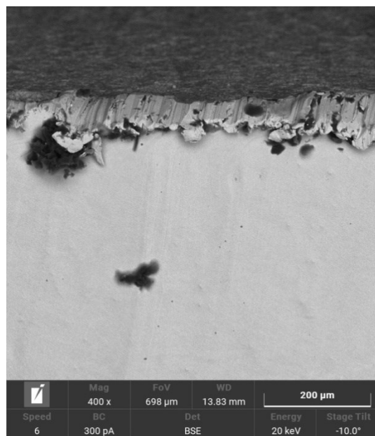
Figura 9 - Analisi SEM del campione A – 316 L effettuata con un ingrandimento di 400x, immagine acquisita con gli elettroni secondari (SE) a sinistra e quella con gli elettroni retro diffusi (BSE) a destra
