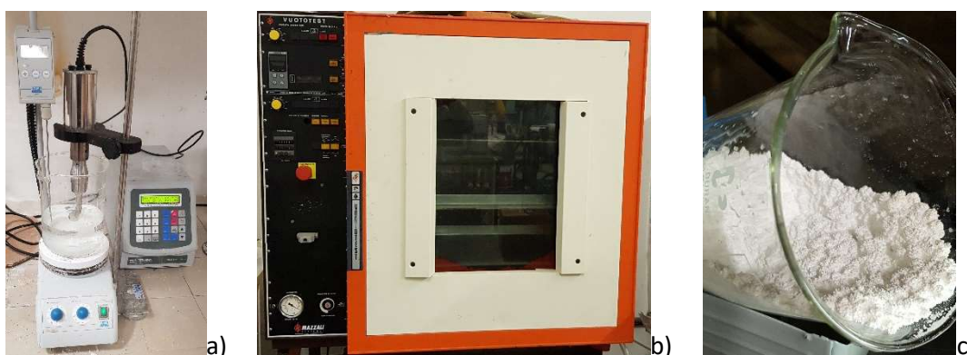
Figura 3. Preparazione dei Sali nitrati di potassio: a) miscelazione adiuvata da ultrasuoni. Deidratazione dei Sali: b) Forno a vuoto, c) Sali nitrati di potassio essiccati
