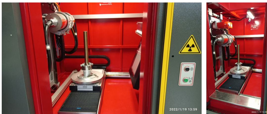
Figura 3-4 Dispositivo per esame radiografico. (Equipment: Gilardoni XE-L HE; Technics: Radiografia Digitale; Tubo RX usato: Minifuoco; Rilevatore: Flat Panel da 16" e 16 bit; KV: 200; mA 3,5; Media Immagini: Alta; Distanza Sorgente RX – Campione; 499,4 mm; Macchia Focale: 0,15 mm; 1 Pixel: 15-29 Micrometri; Ingrandimento: 3,5; Penombra; 1 mm)
