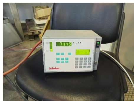
Figura 3-9 Schermata di acquisizione Labview (a) e sistema di controllo del termocristato Julabo (b).
