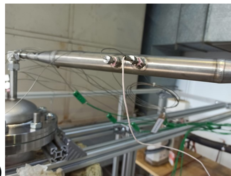
Figura 3-8 Termocoppie uscenti dalla testa del contenitore di LHC01 (a) e punti di misura (una termocoppia ed una termoresistenza) posizionate su una delle due sezioni di misura in ingresso e uscita del prototipo (b).
