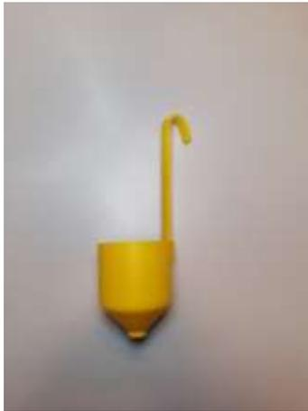
**Figura 26: Viscosimetro DIN 53211**
