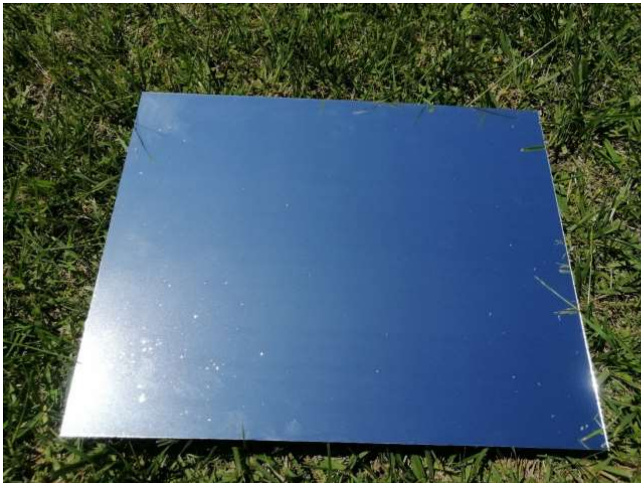
Figura 3 Prototipo di un rivestimento di POSS depositato mediante tecnica spray su uno specchio solare della Società Biancaldese 50 x 50cm
