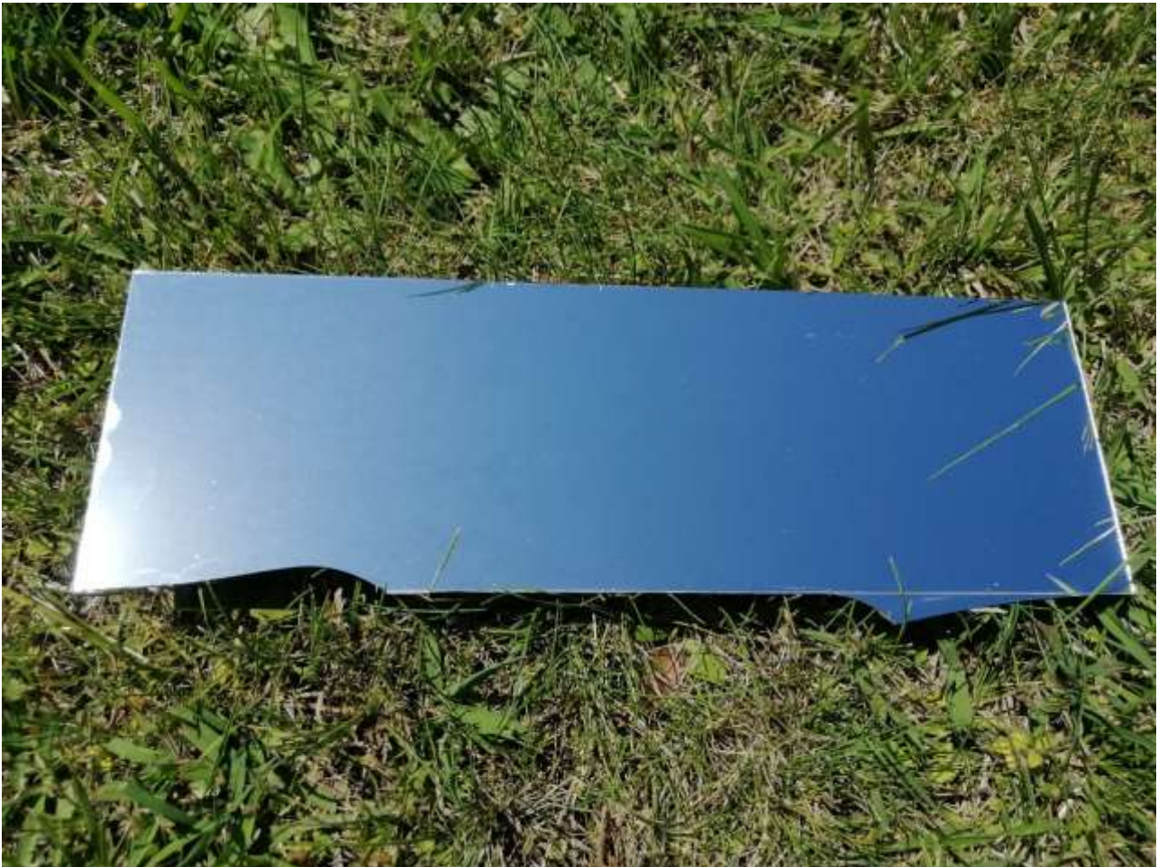
Figura 2 Prototipo di un rivestimento di nitruro di alluminio auxetico depositato mediante sputtering su uno specchio solare della Società Biancaldese 10x30cm
