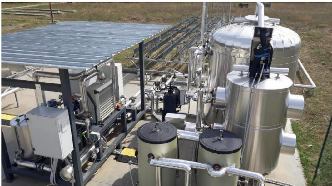
Figura 10 – Foto del circuito E/C che connette il phase-changer al reattore in sperimentazione
